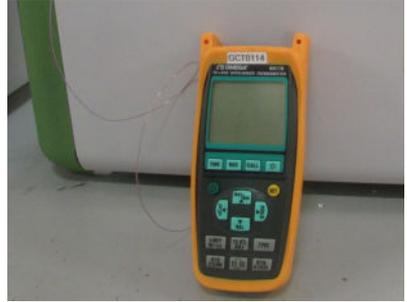
Appareil de mesure de température traçable NIST.
