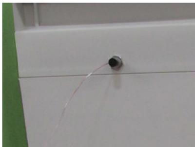
Термопара через входное отверстие и заглушка входного отверстия.
