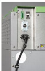
La connexion à l'alimentation en courant alternatif est située à l'arrière du congélateur, dans le panneau électrique encastré. Assurez-vous que l'interrupteur d'alimentation est sur OFF avant d'installer ou de retirer le cordon d'alimentation.
