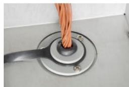
Les fils de thermocouple peuvent être acheminés vers l'intérieur par l'orifice d'accès non bouché. Pour ce faire, utilisez le mastic d'orifice fourni pour sceller les fils sur le capuchon de l'orifice d'accès.
