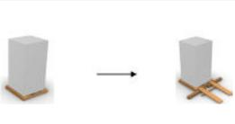
Placez les rampes sur le côté de la palette en alignant les supports des rampes sur les encoches de la palette. Utilisez les accumulations de carton ondulé et le levier pour soutenir les rampes.
