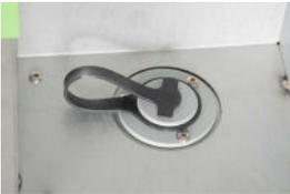
Der Zugangsanschluss befindet sich an der Rückseite des Gefrierschranks im eingelassenen Zubehör-Panel. Der Stopfen des Zugangsanschlusses kann mithilfe der Lasche herausgezogen werden und bleibt mit der Kappe des Zugangsanschlusses verbunden.
