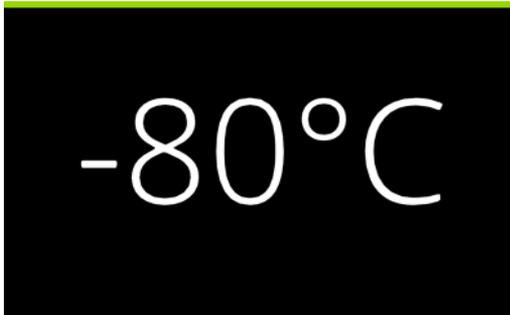
Wird der Bildschirm mit der grafischen Benutzeroberfläche 6 Minuten lang nicht berührt, tritt er in den Schlafmodus ein, in dem nur die Temperatur des Gefrierschranks angezeigt wird.
