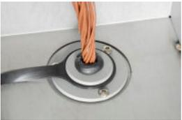
Die Drähte eines Thermoelements können durch den Zugangsanschluss in den Innenbereich des Gefrierschranks geführt werden, wenn der Stopfen abgenommen ist. Benutzen Sie in diesem Fall den mitgelieferten Anschlussdichtstoff, um an der Kappe des Zugangsanschlusses den Raum um die Drähte herum abzudichten.
