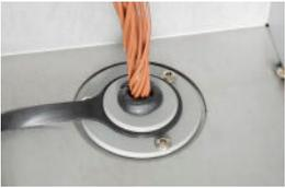
Los cables del termopar se pueden conectar al interior a través del puerto de acceso desenchufado. Al hacerlo, use el sellador de puertos suministrado para sellar alrededor de los cables en la tapa del puerto de acceso.
