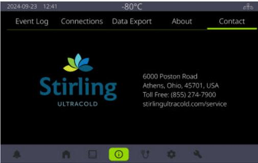
La pantalla **About (Acerca de)** muestra información general, incluidos el modo del congelador, el número de serie del congelador, el número de serie del motor, las horas de encendido y funcionamiento y las versiones de firmware.
