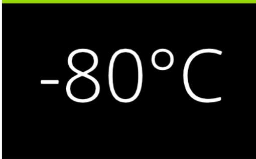
Si no interacciona con la pantalla de la GUI durante 6 minutos, esta entrará en el modo de suspensión, en el que solo se muestra la temperatura del congelador.
