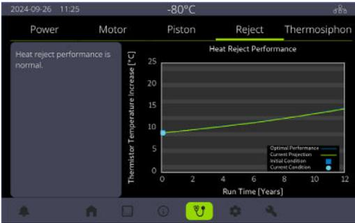
Thermosiphon (Termosifón): traza el cambio de temperatura del termosifón ( $^{\circ}\text{C}$ ) frente al tiempo de funcionamiento (años) para determinar si el termosifón está funcionando con normalidad.
