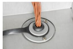
Les fils de thermocouple peuvent être acheminés vers l'intérieur par le port d'accès non bouché. Pour ce faire, utiliser le mastic d'orifice fourni pour sceller les fils sur le capuchon du port d'accès.
