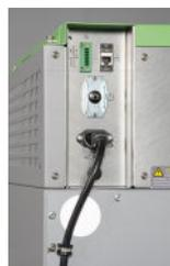
Le raccord d'alimentation est situé à l'arrière du congélateur dans le panneau électrique encastré. S'assurer que le commutateur d'alimentation est à l'arrêt avant d'installer ou de retirer le cordon d'alimentation.
