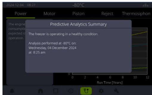
**Power (Puissance)** : la puissance du moteur (watts) en fonction de la durée d'utilisation (années) permet de déterminer si la consommation d'énergie du moteur se situe dans la plage attendue.
