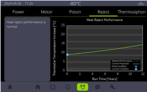
Thermosphon (Termossifão): são apresentados os gráficos de Thermosphon Temperature Change (°C) [Mudança de temperatura do termossifão (°C)] em função de Run Time (Years) [Tempo de funcionamento (Anos)] para determinar se o termossifão está a funcionar normalmente.
