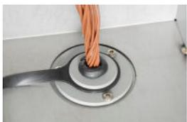
Os fios do termopar podem ser passados para o interior através do orifício de acesso sem o tampão. Para o efeito, utilize o isolamento da porta fornecido para a selagem em redor dos fios na tampa do orifício de acesso.
