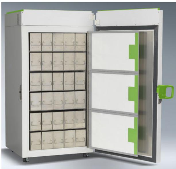
As prateleiras são ajustáveis em incrementos de 12,7 mm (0,5 in.). Depois de remover uma prateleira, os 4 cliques podem ser colocados em diferentes posições nas quatro pilastras. Para retirar um clipe, empurre para cima, perto da dobra e, depois, puxe para fora. Cada clipe tem dois dentes para inserção nos orifícios da pilastra. Quando ajustar os cliques, use os números de referência marcados nas pilastras para garantir que os quatro cliques estão à mesma altura.
